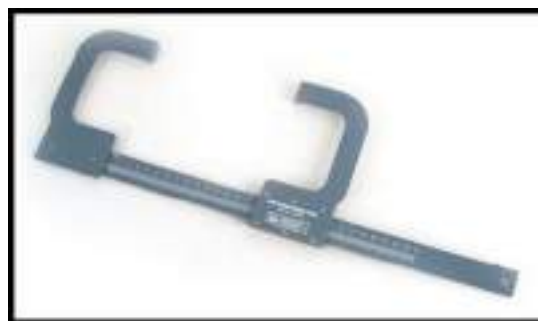
Anexo 6. Antropómetro Lafayette chico 30 cm Modelo SKU: LA-01291 Material: aluminio. Para registro de medidas antropométricas de: codo, muñeca, 3er metacarpiano, rodilla, tobillo.
